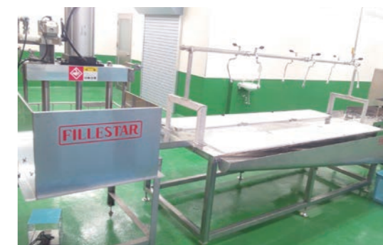
ヘッドカッターおよびトリミング Head Cutter and the table for trimming 切头机 以及
