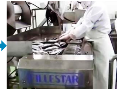
ヘッドカッター投入口 Inlet table of Head Cutter 切头机投入口
