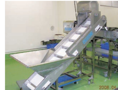
原料組み上げコンベアー(原料供給) Elevating Material Conveyor (Supplying the material) 原料提升输送机 (材料供应)
