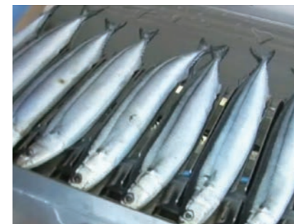
原料をトレイに並べるだけ Only setting material on the slot of chained conveyor 只需在托盘上安排原料
