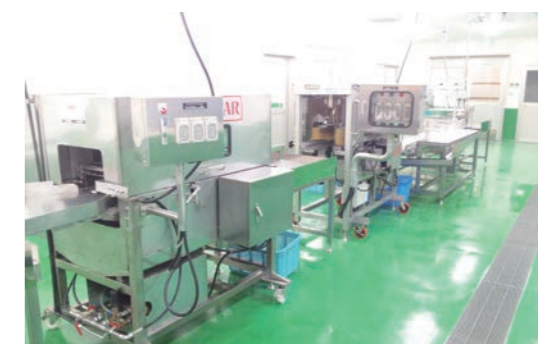
ウロコ取りおよび血合い洗浄 Scale Remover and flash the blood meat 去鳞机以及洗去血合肉
